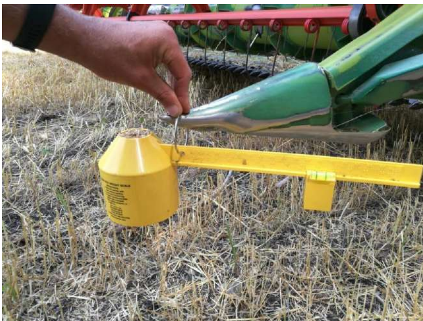
Рисунок М16 - Определение удельного веса зерна
