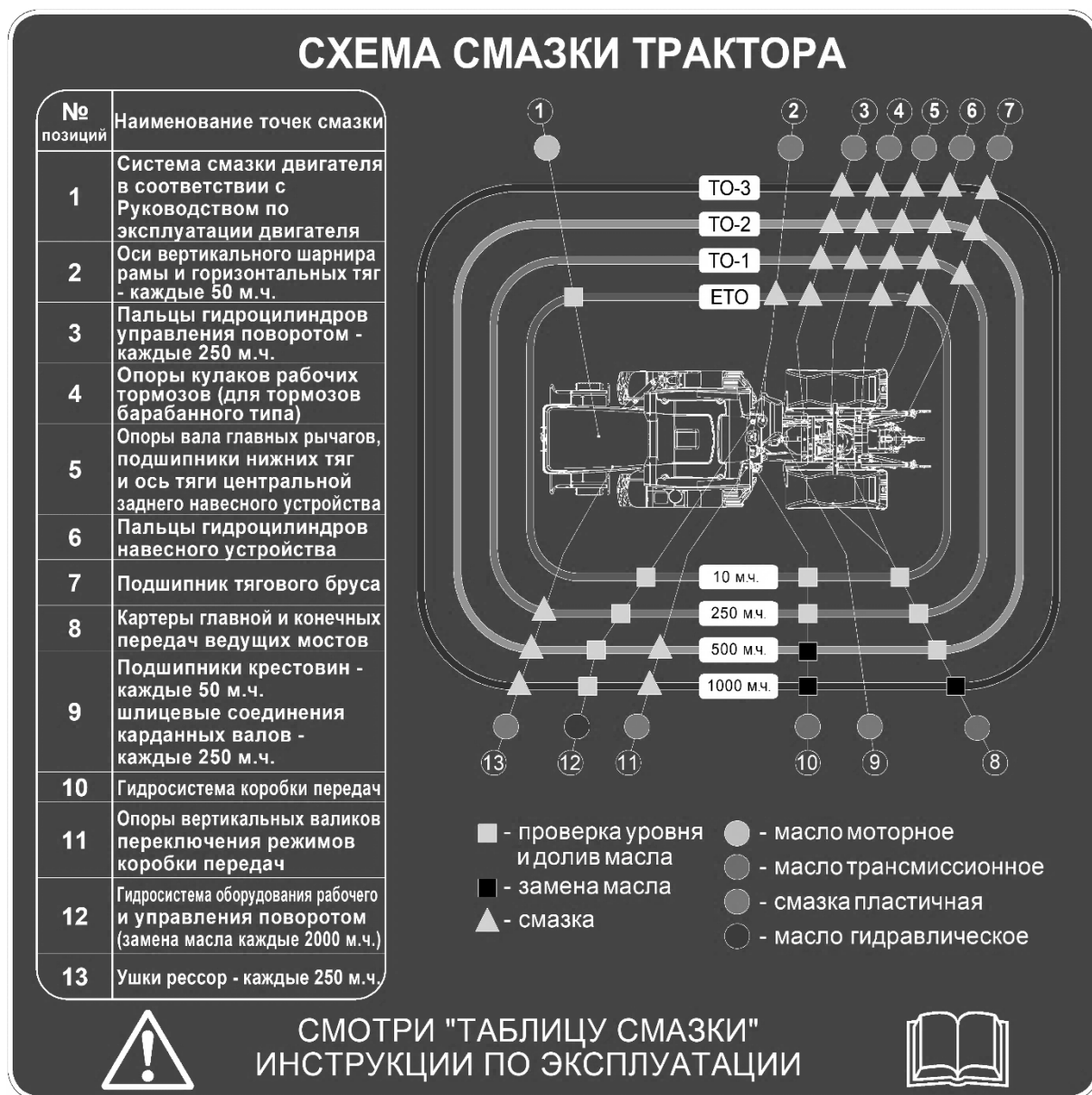
Рисунок 52 – Схема смазки трактора
