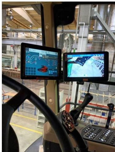
Моноблочная панель управления комбайном U-PAD, современный джойстик MULTI GRIP, бортовой компьютер с цветным экраном и USB-разъём для подключения внешних устройств.
