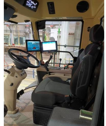
Кресло на пневматической подвеске с множеством регулировок, а также новые рулевая колонка и рулевое колесо, всё это позволяет оператору настроить удобное рабочее положение и достигать максимальных результатов на протяжении всей смены.
