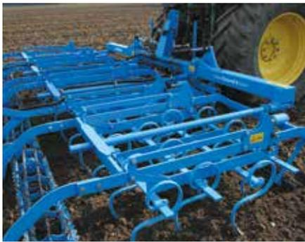
**Прочная рама из пружинной стали**
