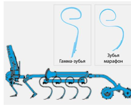
**Секция пружинных зубьев**
